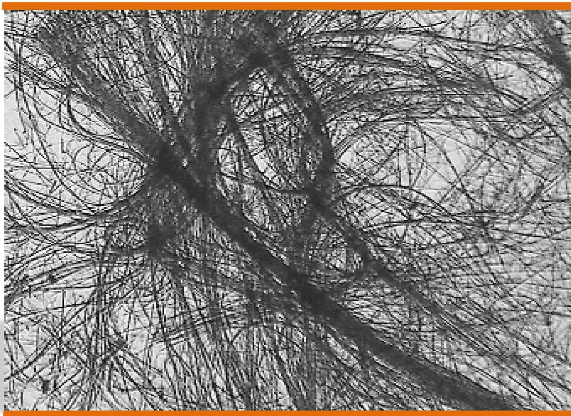
“放桶”工艺制备的缬沙坦显微镜照片
